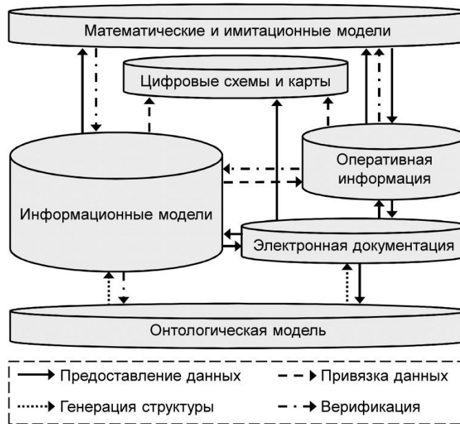
Рис. 2. Взаимодействие компонентов цифрового двойника
