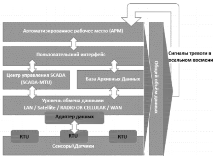
Рис. 2. Модель системы управления водоснабжения
