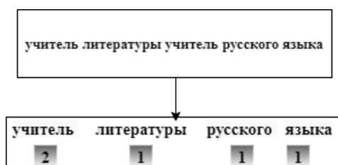
Рис. 1. Представление частот слов в виде вектора с помощью модели “мешок слов”
