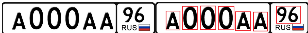
Рис. 2 Поиск местонахождения символов на номерном знаке (сегментация символов)
