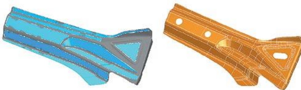
Рис. 3. Триангуляция модель (слева) и "выглаженная" (справа). Для округления поверхностей используется программное обеспечение PowerSHAPE.
