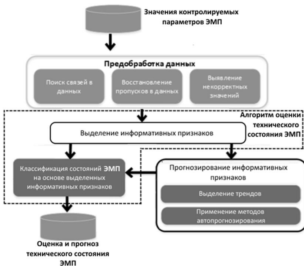
Рис. 5. Схема анализа данных в режиме использования алгоритма оценки технического состояния ЭМП
