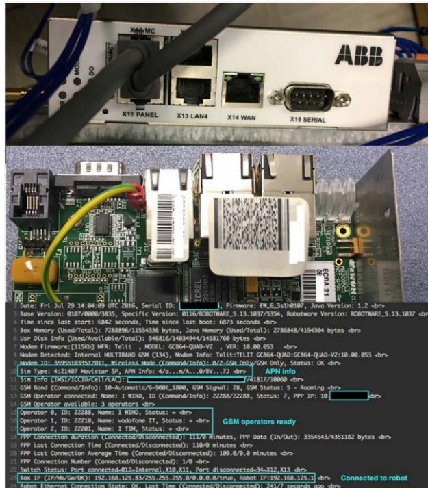
Рис.2. Сервисный бокс ABB (промышленный маршрутизатор eWON с ребрендингом), предоставляющий возможность удаленного подключения к роботу
