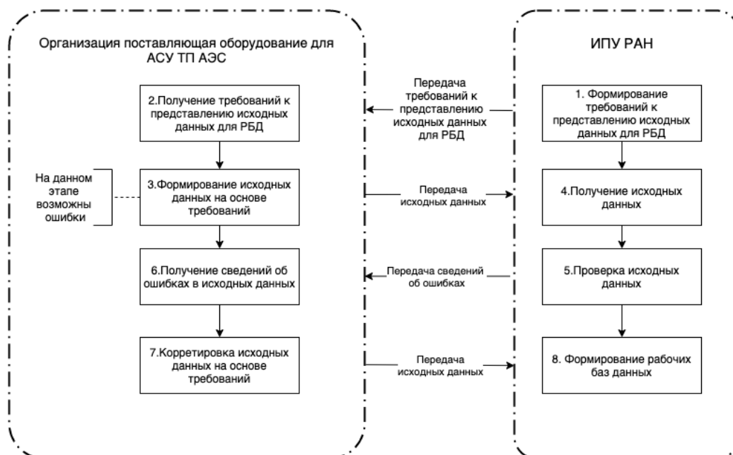
Рис. 1. Схема взаимодействия организаций-разработчиков АСУТП при проектировании РБД
