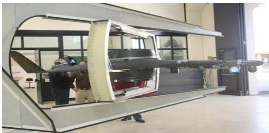
Рис. 4. Специальный стенд наземных испытаний самолёта-конвертоплана.
